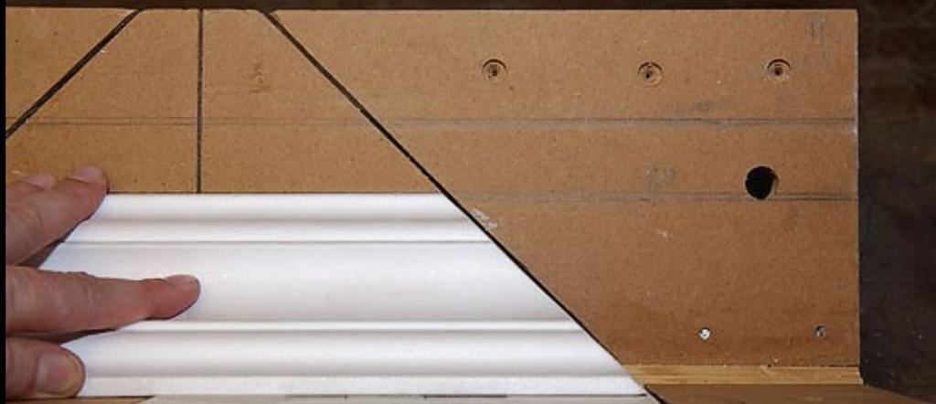
Richtig - Leiste genau an der Linie der Schenkellänge (80mm/80C) ausgerichtet - ergibt exakten Gehrungsschnitt für Ecke
