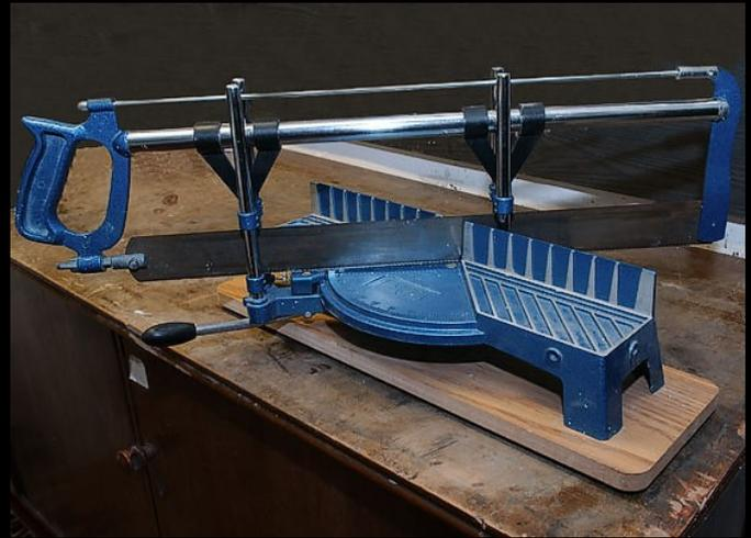
Der Nachteil dieser Sägevorrichtung ist, dass die Auflagefläche für die Leiste oft nicht ausreicht und dadurch die Leiste beim Sägen schnell verkantet und so die Schnitte ungenau werden. Wichtiger Hinweis: nur wenn sich die Eck-Leiste in der gleichen Position wie an der Decke befindet, wird der 45 Grad-Winkel-Schnitt gelingen.
